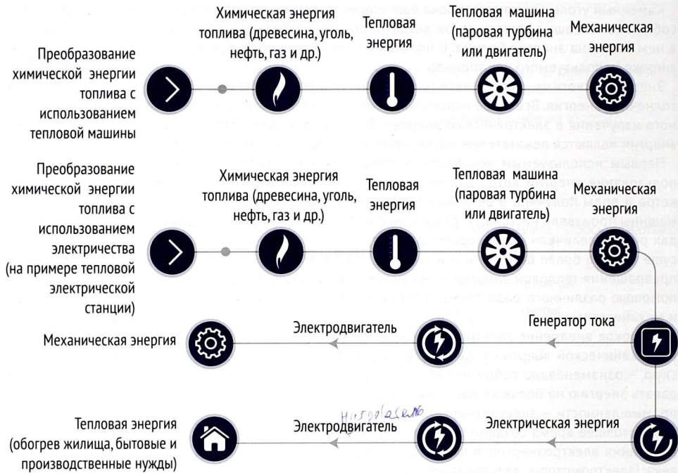
Рисунок 1.15. Преобразование энергии на тепловой электрической станции
