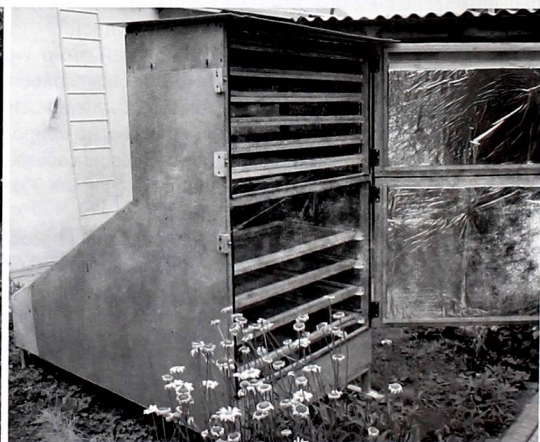
Рисунок 2.20. Солнечная сушилка, использующая не прямые солнечные лучи
